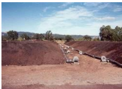
Ilustración 17: Proceso de aireación forzada
